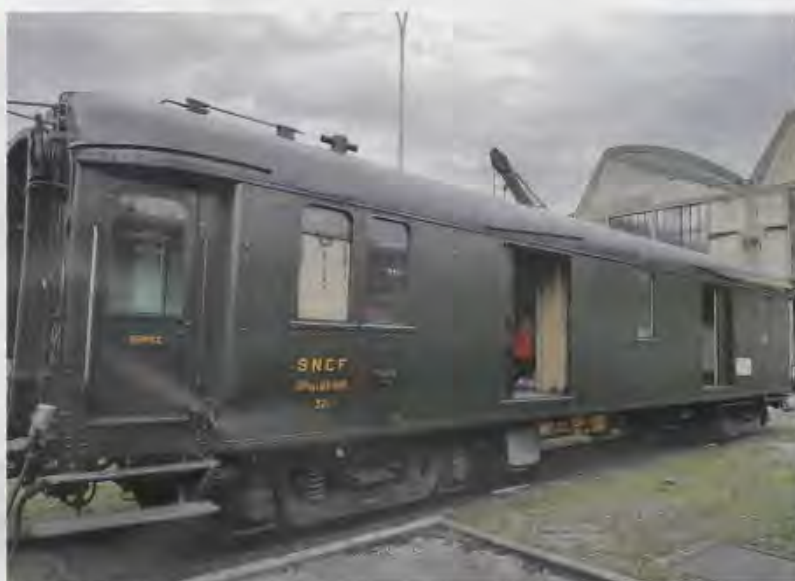
Le fourgon date de 1928. Ce matériel quasi centenaire a été entièrement restauré par les bénévoles du Train à Vapeur d'Auvergne. Les travaux ont duré deux ans pour redonner au véhicule son aspect d'origine.
