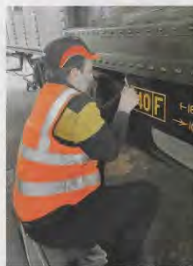
Dernière étape du chantier, le marquage en Jaune bouton d'or, référence 411 !
