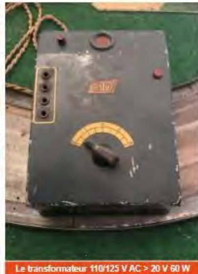
Le transformateur 110/125 V AC > 20 V 60 W
